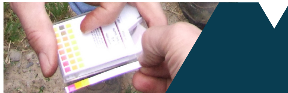
Tiras indicadoras para controlar el pH (Foto: ECA Tárrega).
